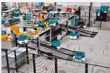
La prouesse technique d'Exotec Solutions est encore bien plus bluffante. Non seulement les robots de la start-up française sont capables de travailler en équipe au milieu des étagères, mais ils sont aussi capables de s'agripper aux racks pour grimper jusqu'à 10 mètres de haut afin de récupérer le bac de produits désiré.
